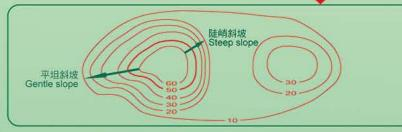
等高線之間的距離越密,表示地勢越陡峭。 The closer the contour lines are, the steeper the slope is.
